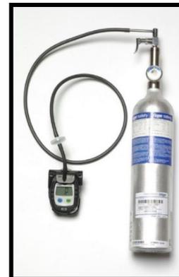
Fig. 5. Bump test kit.
